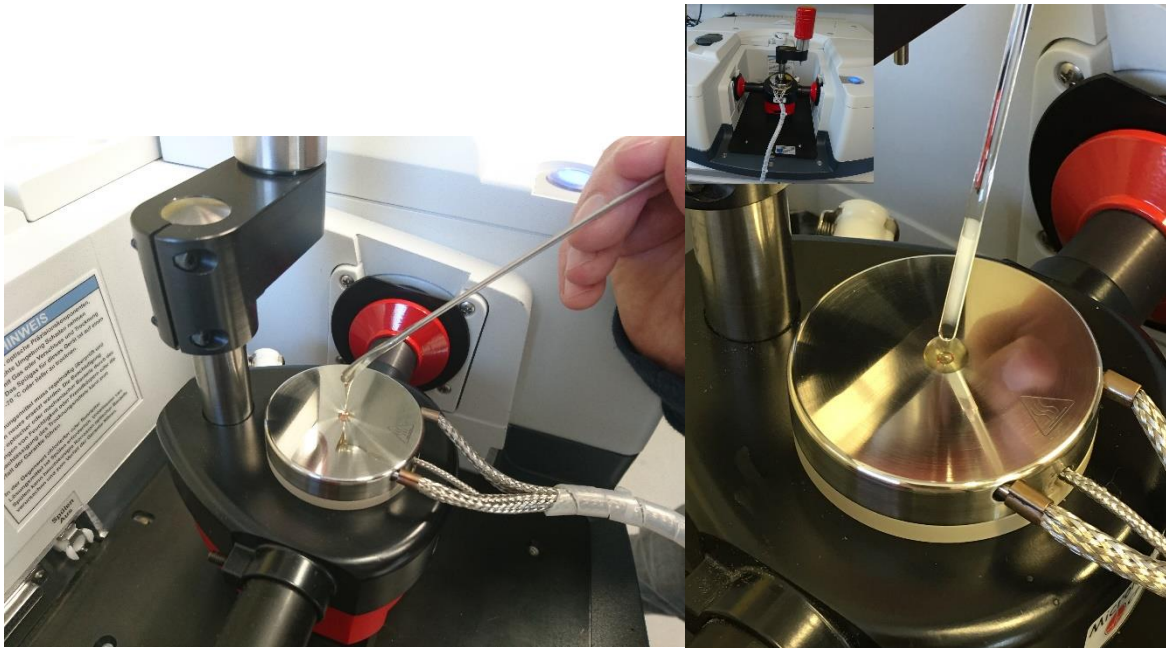
Abbildung 5: Die Infrarotspektroskopie kann zur Analyse von Honig (linkes Bild) und Wachs (rechtes Bild) eingesetzt werden.
