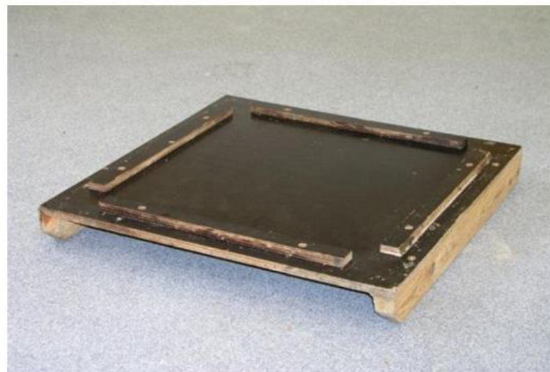
Transportboden für Zargen erspart umstapeln
