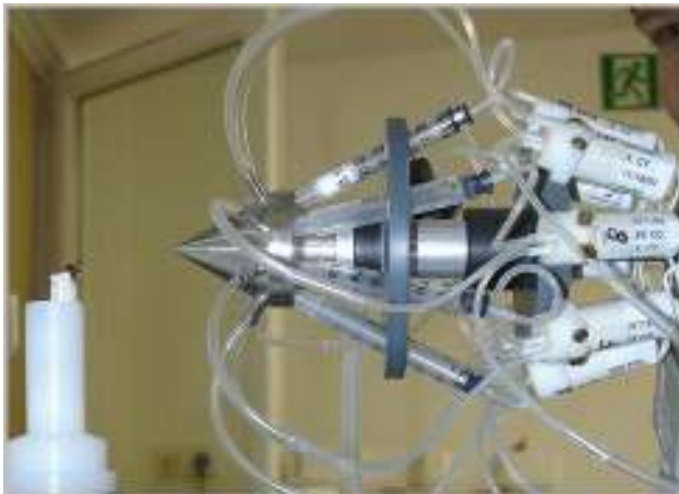
Lerntest: Apparatur zur Durchführung des Rüsselreflextestes (PER).
